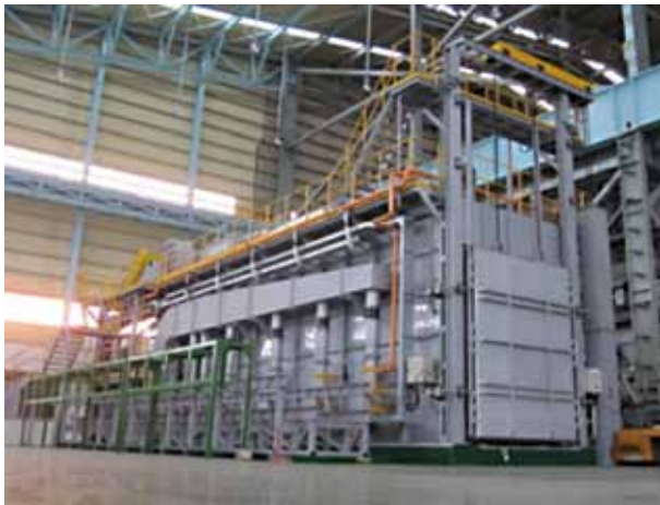
中鋼鋁業 90 噸鋁合金板光輝退火爐
